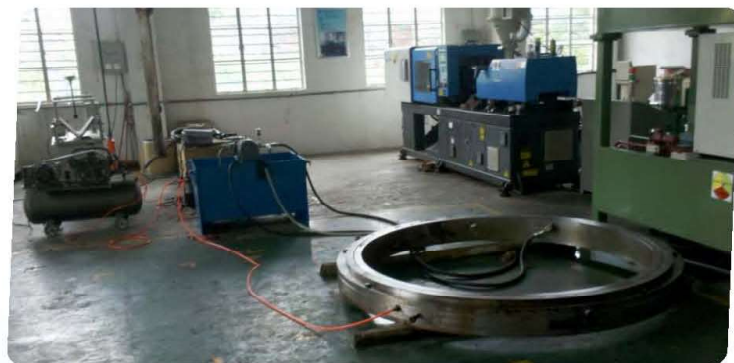
空气围带密封试验装置及密封截面简图
